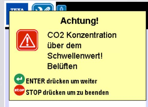
Die TEXA Software warnt den Anwender, wenn aufgrund des Ablassens von CO<sub>2</sub> aus der Anlage die Arbeitsumgebung nicht mehr sicher ist.
