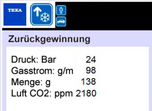
Während dem Ablassen des Kältemittels aus der Anlage wird dessen Menge und der Druck des Systems angezeigt.
